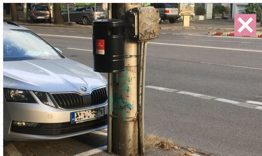
12 Příklad nevhodného umístění koše do velké výšky. Výška otvoru přesahuje 1 m, kôš sa stáva neprístupným pre deti a ľudí so zdravotným znevýhodnením. Bratislava, Námestie 1. mája
